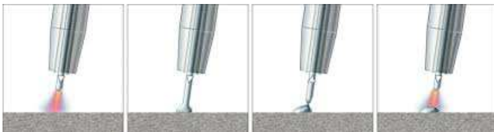
Obr. 14 přenos kovu metoda CMT [23]
