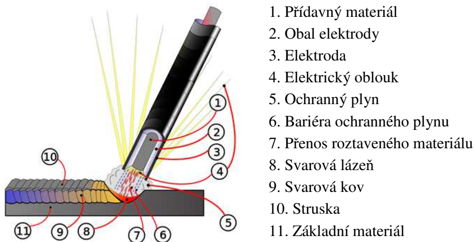
Obr. 9 Tvorba svaru u metody Ruční obloukové svařování [10]
