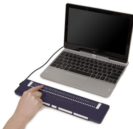
Obrázek 6 – Braillový řádek připojený k počítači (zdroj: spektra.eu, 2022)
