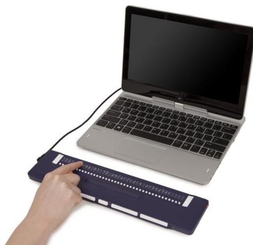
Obrázek 6 – Braillový řádek připojený k počítači (zdroj: spektra.eu, 2022)
