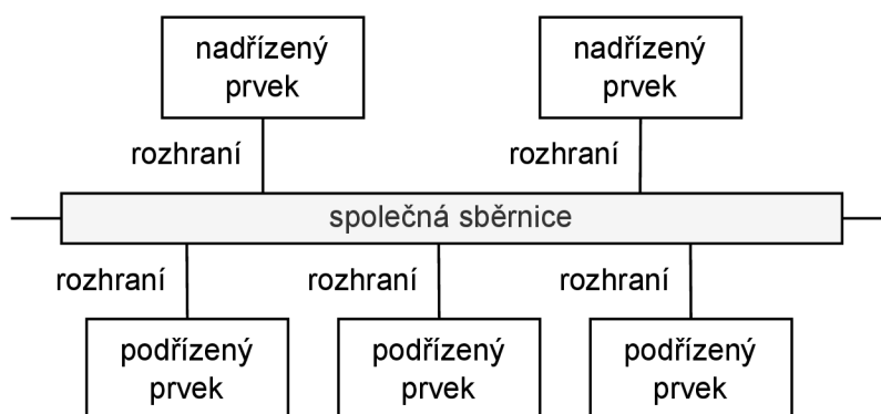
Obrázek 2.3: AXI sběrnice s připojenými prvky.
