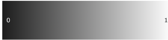
Obrázek 3.5: Interval jasu (množství energie) v odstínu barvy.
