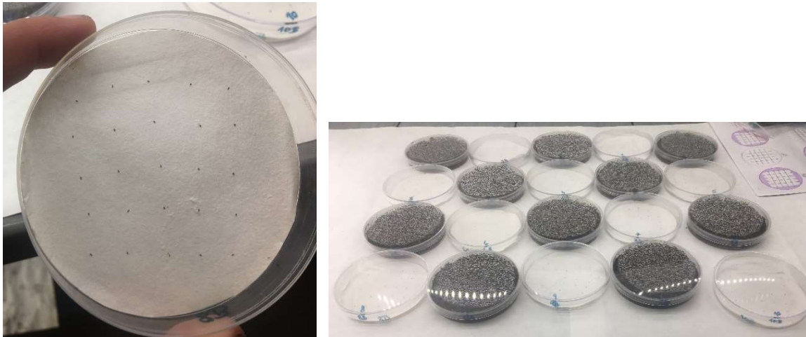
Obr. 5: Vlevo: Rozmístění semen v Petriho misce, vpravo: rozmístění Petriho misek v klimaboxu (foto Barbora Bělovská).
