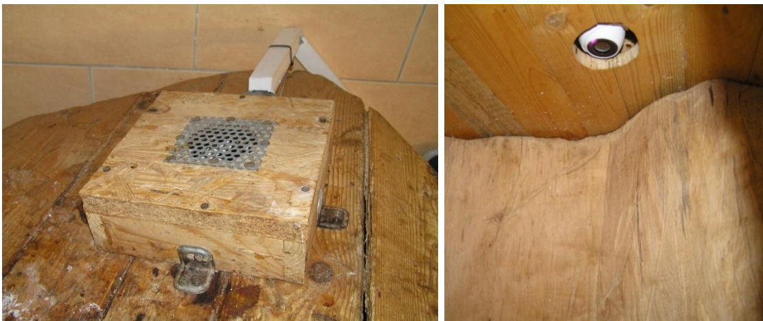
Obrázek č. 13: Kamerový systém je zabudován ve stropní části hnízdni dutiny.
