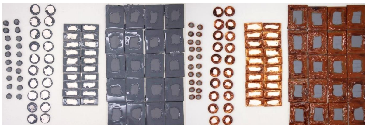
Obrázek 35 – Vzorky po aplikaci silikonu (vlevo) a epoxidu
