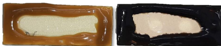
Obrázek 55 - Vzorek s epoxidovou vrstvou před (vlevo) a po měření RT křivky v olejové lázni
