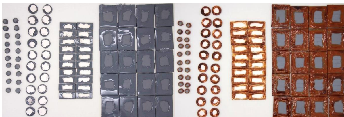
Obrázek 35 – Vzorky po aplikaci silikonu (vlevo) a epoxidu
