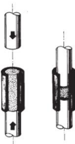
Obrázek 25 - Schéma dvoustranného lisování za studena [56]
