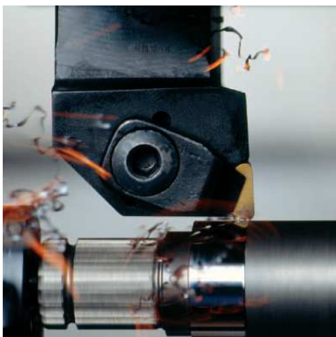
Obr. 3.3 Soustružení VBD s břitem z CBN 11
