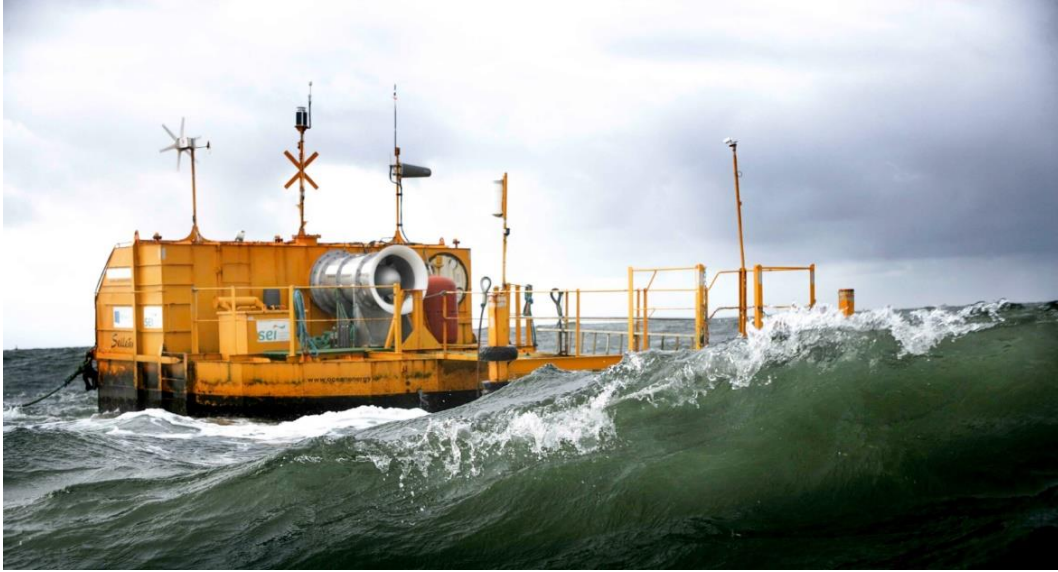
Obrázek 2.2: Fotografie z testování HK systému na bázi oscilujícího vodního sloupce v 1/4 měřítku od firmy Ocean Energy [10]
