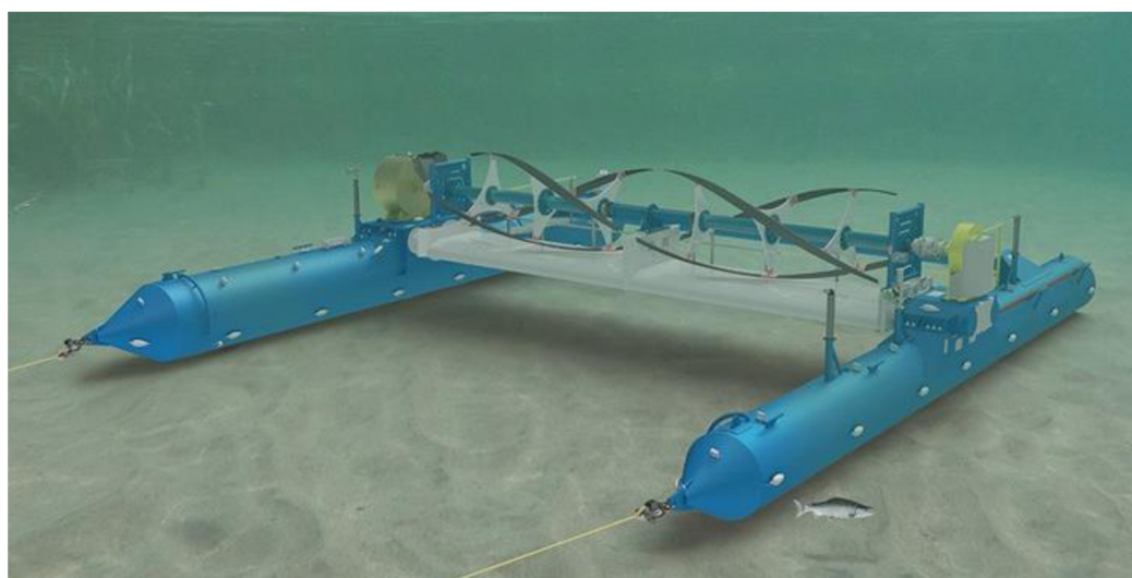
Obrázek 2.10: Vizualizace systému RivGen v říčním prostředí [19]
