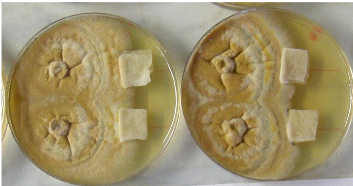
Obr. 28 Detail kontrolní varianty – přerůstání terčků myceliem
