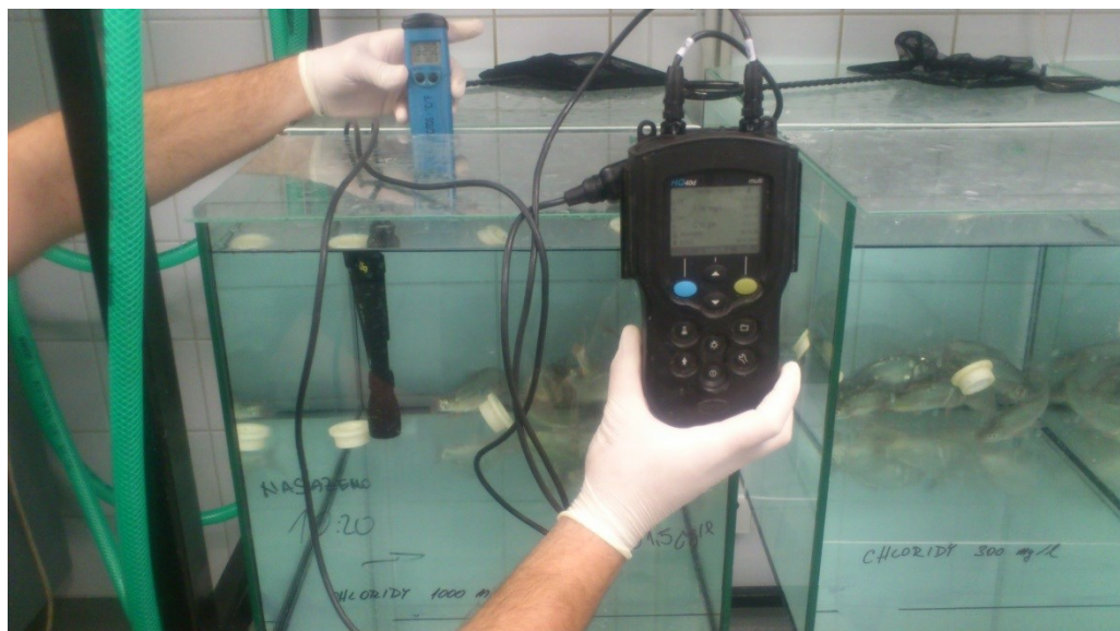
Obr. 8 Měření fyzikálně-chemických parametrů vody přístroji Hanna a Hach (Zdroj: foto autor)
