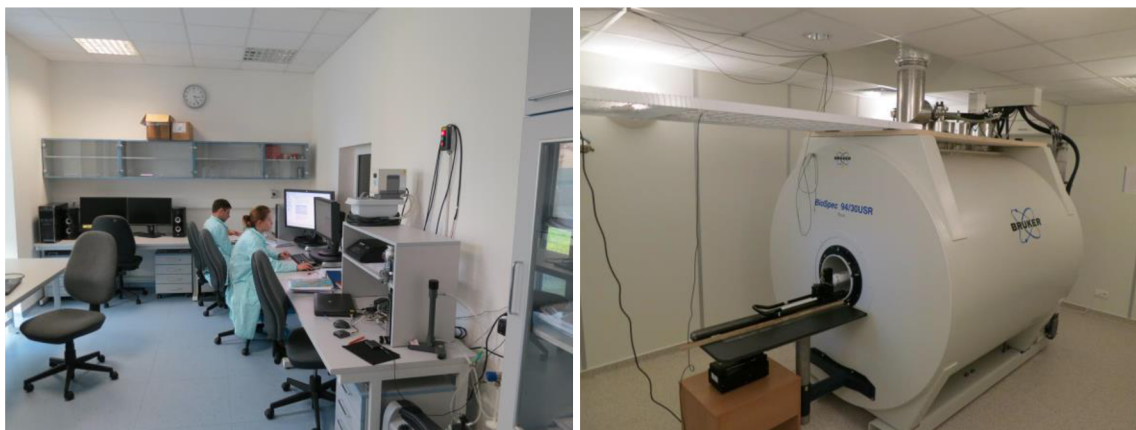
Obr. 39 Riadiace pracovisko v magnetáriu vľavo a Magnet (Bruker 9.4 T) vpravo
