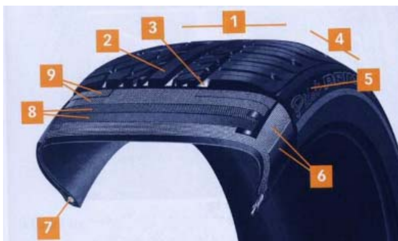
Obr. 14 konstrukční prvky pneumatiky[7]
