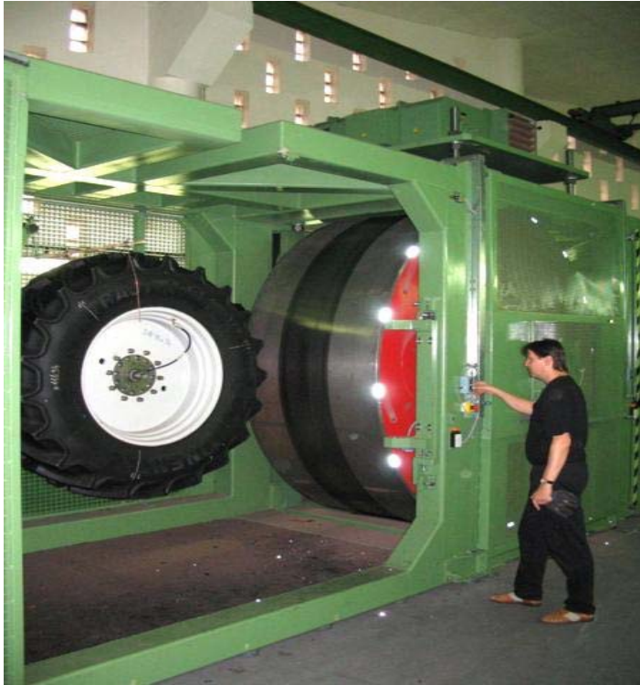
Obr. 21 Zkouška pneumatiky na zkušebním bubnu[12]
