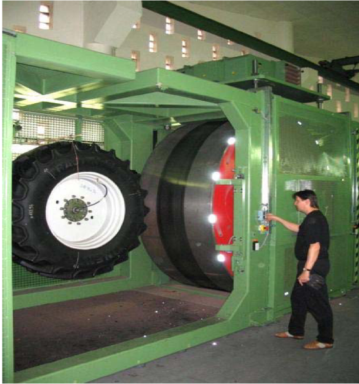
Obr. 21 Zkouška pneumatiky na zkušebním bubnu[12]
