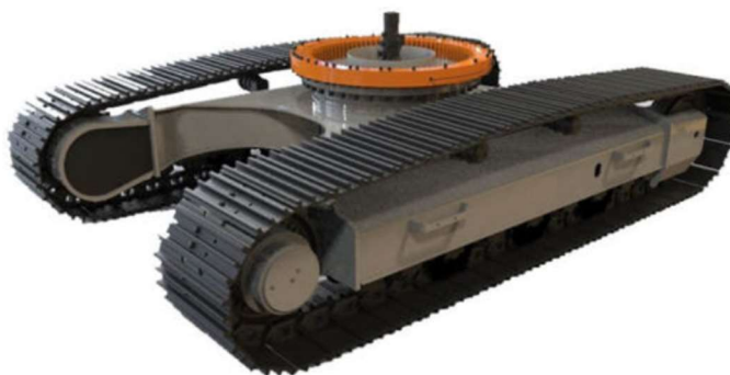
Obr. 2.2 Nedělený svařovaný rám podvozku pásových rypadel [11]
