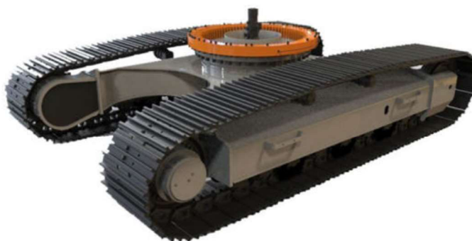
Obr. 2.2 Nedělený svařovaný rám podvozku pásových rypadel [11]
