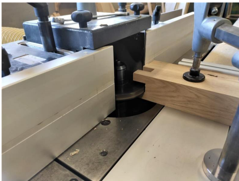
Obr. 8.4 Frézovanie drážky na stolovej nohe
