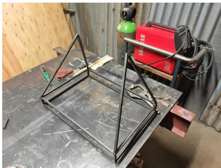
Obr. 8.6 Výroba zváratej konštrukcie
