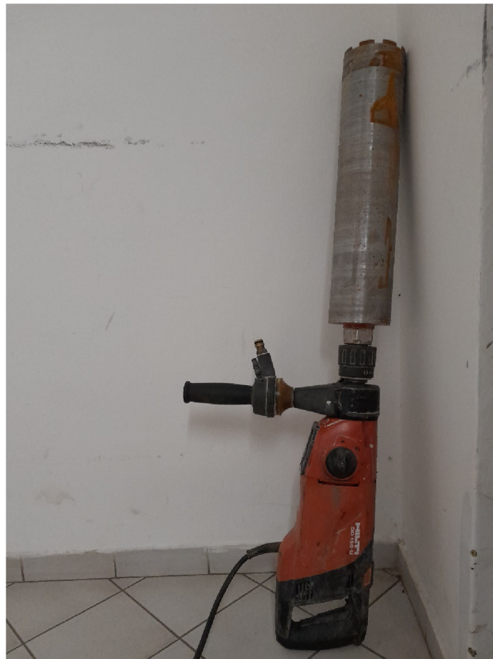
Obr. č. 16: Vrtačka HILTI DD 150-U s diamantovou vrtací korunkou (Sismilich, 2023).
