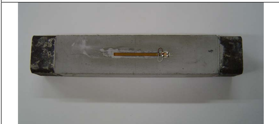
Obr. 4.25 Elementární zkušební vzorek osazený tenzometrem
