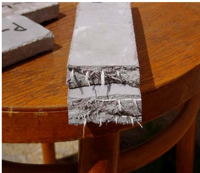
Obr. 4.2 Porušený elementární zkušební vzorek – vyztužený sítí tvořenou skelnými vlákny
