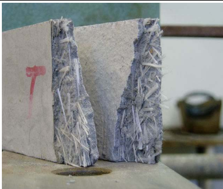
Obr. 4.3 Porušený elementární zkušební vzorek – vyztužený rozptýlenou výztuží tvořenou skelnými vlákny
