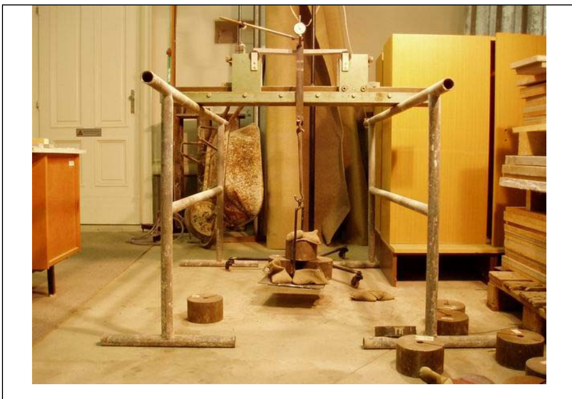
P.26 Zatěžovací sestava elementárních vzorků
