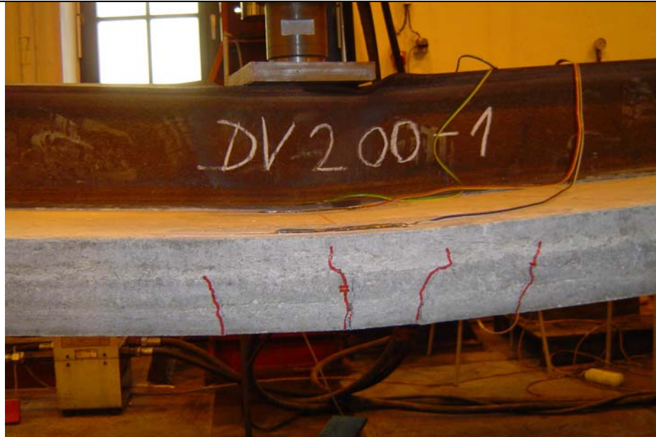
Obr. 4.64 Porušené zkušební těleso s betonářskou výztuží, s označením magistrálních trhlin
