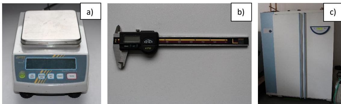
Obrázek 13: a) digitální váha b) posuvné měřítko c) klimatizační komora (autor)
