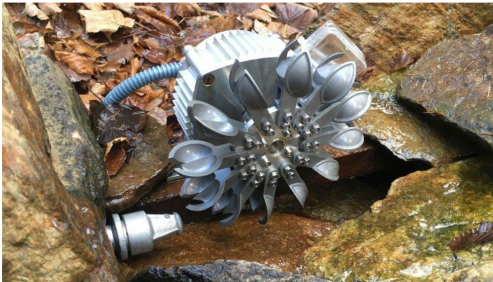
Obr. 2.4: Peltonova turbína s dýzou z požární hadice [17]
