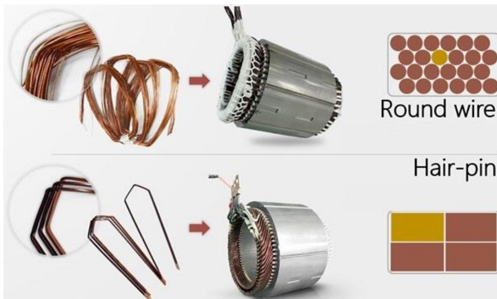
Obr. 6 - Různá vinutí statoru [22]
