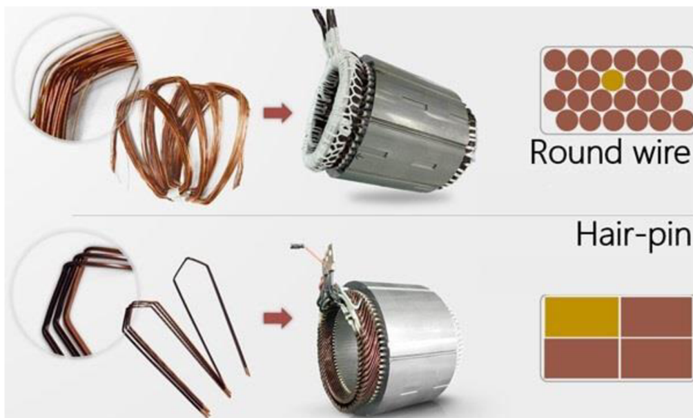
Obr. 6 - Různá vinutí statoru [22]
