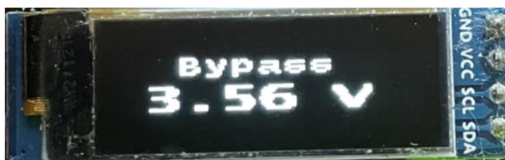
Obrázek 30: Zvolený Bypass režim s měřeným napětím
