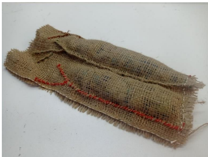
Obrázek 39: Zkouška vycpání pytle pomocí molitanové drti
