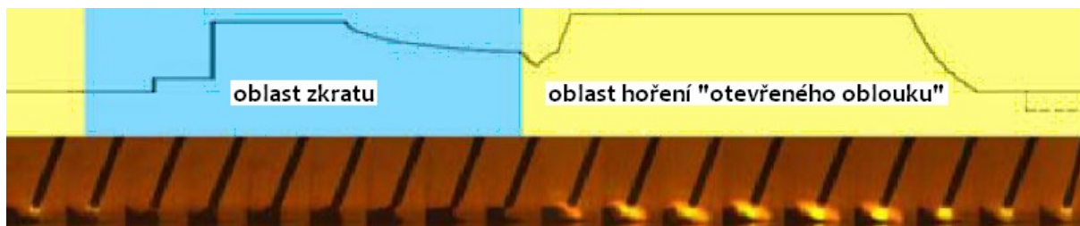
Obr. 17: Proudová vlna procesu Fast Root v okamžiku přenosu kapky kovu do svarové lázně [10]
