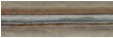
Obr. 33: Ocelový plech 1 mm; tupý spoj; 1 mm mezer; 1 mm drát G4Si1 [17]
