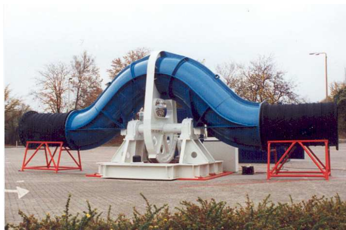
Obrázek 19 Proplachovací zařízení s natáčecím kolenem [15]
