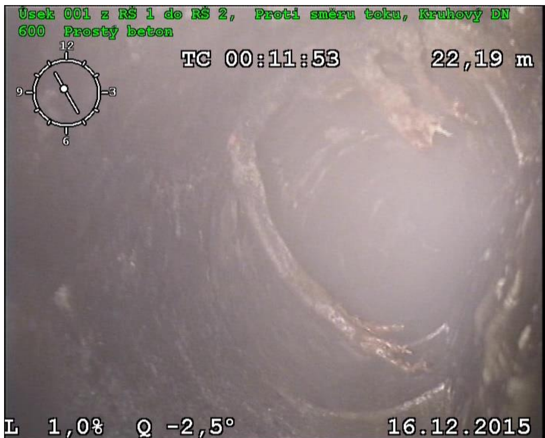
Obrázek 8.9 – Úsek Š1 – Š2, hlavní křivé kořeny, zúžení 20%, staničení 23,0m – BBAA
