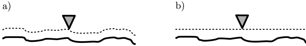
Obrázek 1.2: Trajektorie hrotu během měření: a) měření s použitím zpětné vazby, která udržuje velikost síly působící mezi hrotem a vzorkem konstantní, b) měření bez zpětné vazby, kdy se velikost síly mění dle vzdálenosti mezi hrotem a vzorkem.
