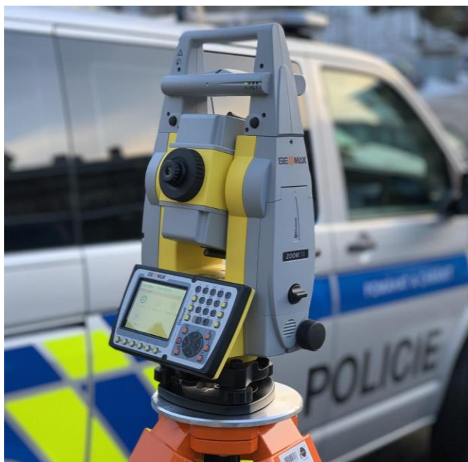
Obrázek č.3 - Robotická totální stanice Zdroj: https://www.policie.cz/clanek/robotizovane-totalni-stanice-jsou-novymi-pomocniky-dopravnich-policistu.aspx
