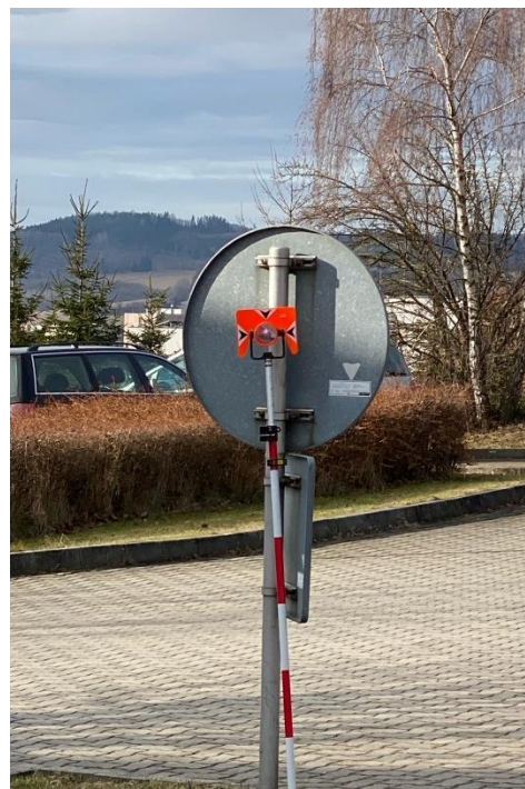
Obrázek č. 11 - Hranolová tyč s odrazným zrcátkem zarytá v zemi před dopravní značkou Zdroj: vlastní zpracování
