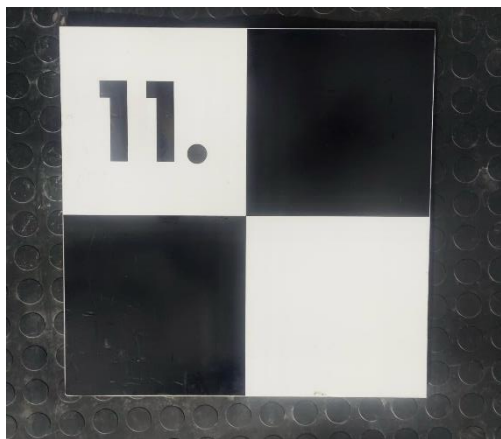
Obrázek č. 5 - Čtverec pro potřeby zaměření dronů na dopravních nehodách Zdroj: vlastní zpracování
