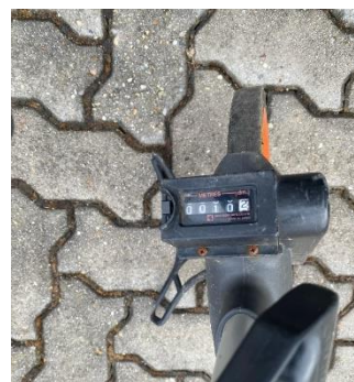
Obrázek č.9 - Krokoměr s minimální hodnotou 10cm na měřícím kolečku Zdroj: vlastní zpracování
