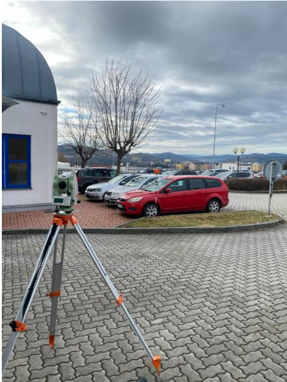
Obrázek č.12 - Měření vzdálenosti k autu za pomoci TMS Zdroj: vlastní zpracování
