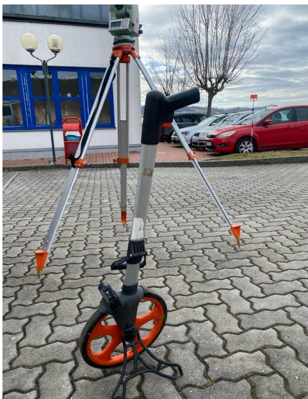
Obrázek č. 7- Mechanické měřící kolečko v porovnání s TMS Zdroj: vlastní zpracování
