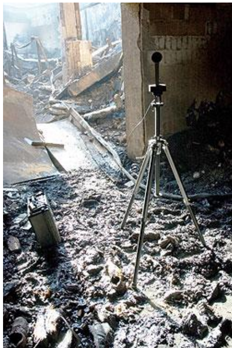
Obrázek č. 1 - Sférická kamera Spheron VR Zdroj: https://www.policie.cz/clanek/utvary-policie-cr-celorepublikove-utvary-kriminalisticky-ustav-praha-zpravodajstvi-kup-na-pragoalarmu.aspx
