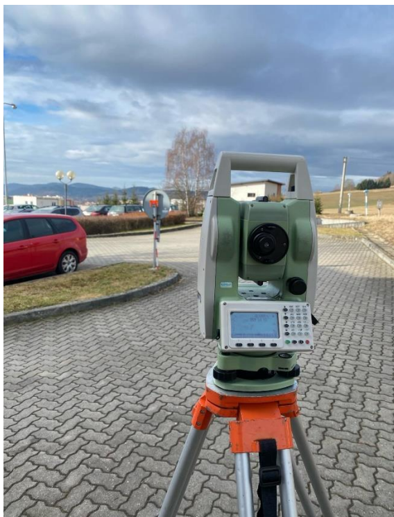
Obrázek č. 10 - Totální měřicí stanice po sestavení, směřující laserovým paprskem na hranolovou tyč Zdroj: vlastní zpracování
