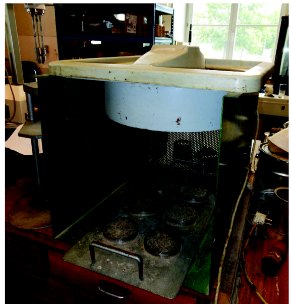
Obrázek 13: Chlazení vzorku proudem vzduchu
