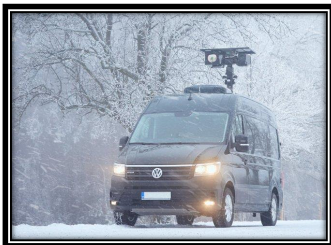
Obrázek 21 Mobilní vozidlová termovize v terénu
