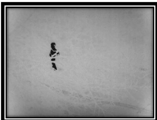
Obrázek 54 Pohled na osobu termovizí ve volném terénu na vzdálenost cca 100 m, kdy před osobou se nachází překážka (strom)
