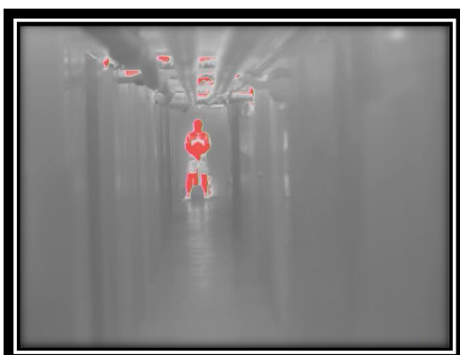
Obrázek 66 Pohled na osobu termovizí v úplné tmě (obě ruce před sebou)
