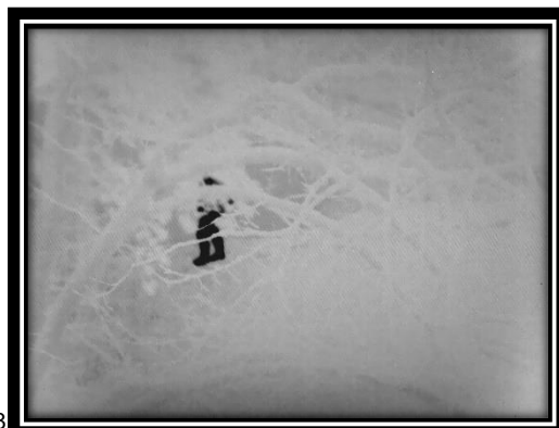
Obrázek 55 Pohled na osobu termovizí ve volném terénu na vzdálenost cca 100 m, kdy před osobou se nachází překážka (strom)
