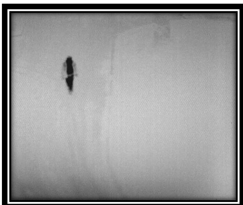
Obrázek 51 Pohled na osobu termovizí ve volném terénu na vzdálenost cca 100 m
