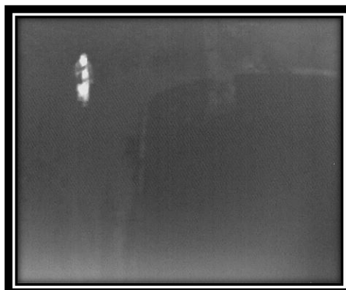
Obrázek 52 Pohled na osobu termovizí ve volném terénu na vzdálenost cca 100 m v jiném režimu
