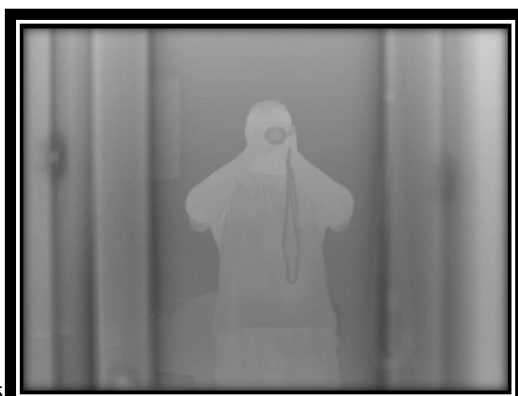
Obrázek 62 Pohled na prosklené dveře, kdy za nimi se nachází osoba (je vidět pouze odraz pozorovatele)
