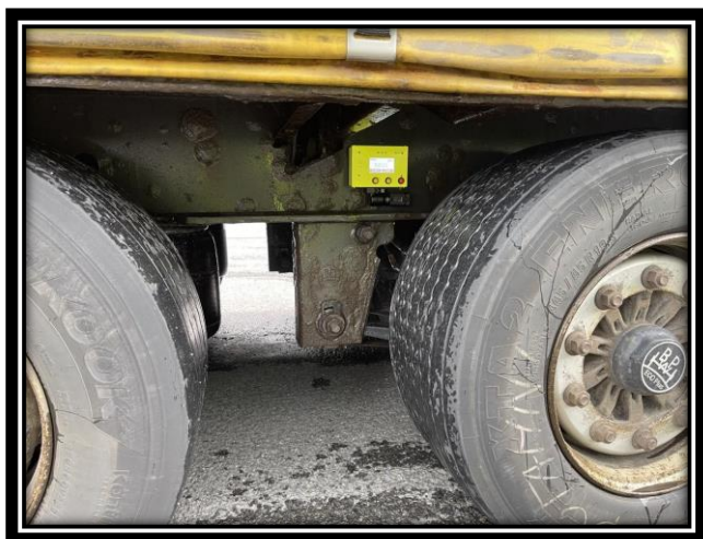
Obrázek 30 Přístroj MMD01 umístěn na nákladním vozidle
