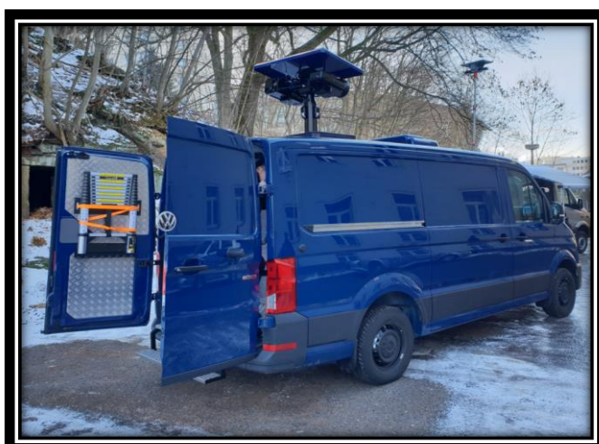
Obrázek 22 Pohled na vozidlovou termovizi z venku
