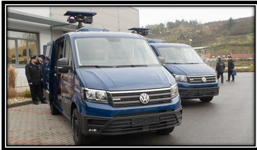
Obrázek 17 Mobilní vozidlová termovize Volkswagen Crafter
