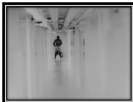
Obrázek 65 Pohled na osobu termovizí v úplné tmě (ruka za zády)
