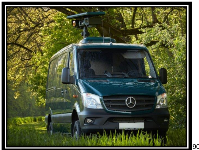
Obrázek 18 Mobilní vozidlové termovize v terénu
