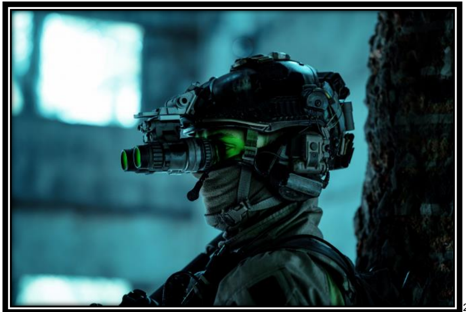
Obrázek 1 Ukázka umístění noktovize na přilbě
