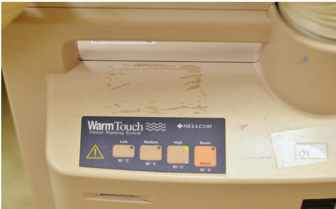
Obrázek 10 Aktivní ohřevný systém poháněný horkým vzduchem WarmTouch™, model WT-5800, (M. S. M.)
