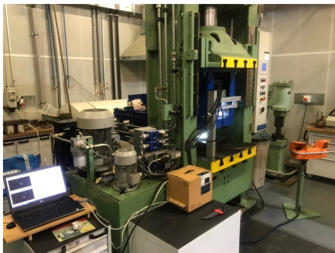
Obr. 31 Hydraulický lis s připraveným fotogrammetrickým softwarem
