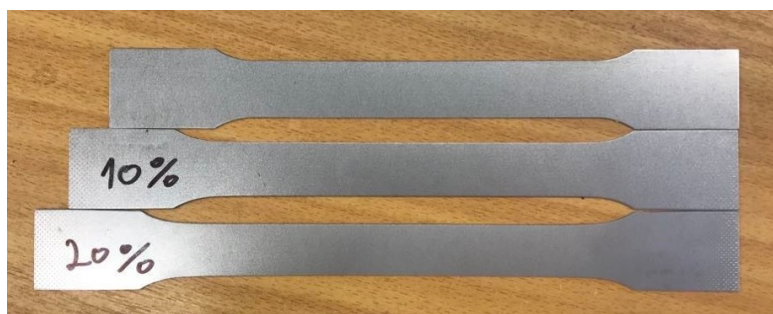
Obr. 30 Deformované vzorky na určité hodnoty poměrného prodloužení
