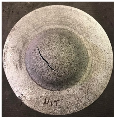
Obr. 35 Vzorek po provedení Nakazima testu
