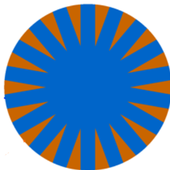
Obr. 14 Přístřih pro válcový výtažek s vyznačenou oblastí přebytečného materiálu
