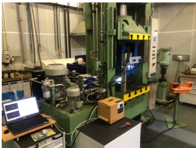
Obr. 31 Hydraulický lis s připraveným fotogrammetrickým softwarem
