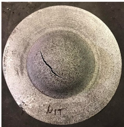
Obr. 35 Vzorek po provedení Nakazima testu
