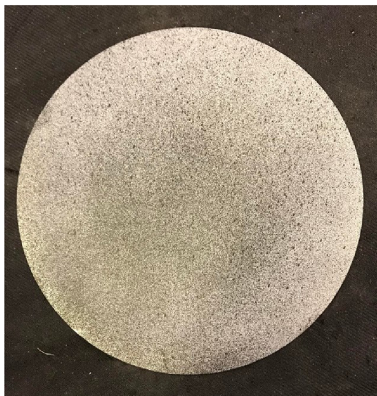
Obr. 33 Vzorek opatřený patternem
