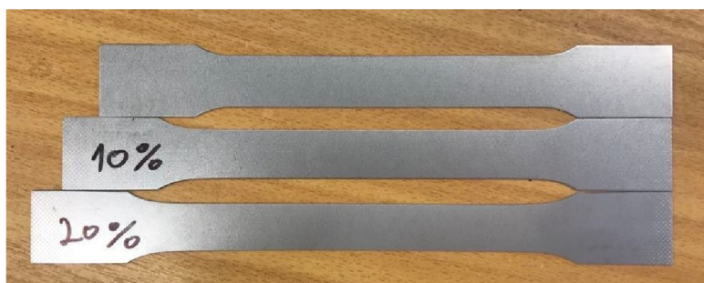
Obr. 30 Deformované vzorky na určité hodnoty poměrného prodloužení
