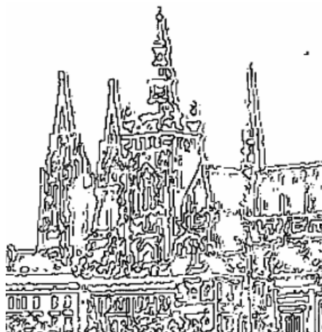
Obrázek 20: Prahování obrázku LoG (po filtraci maticí 2x2) - \sigma = 0,20
