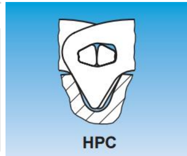
Obrázek 20. Hluková hladina a profil zubu u řetězu HPC. [12]
