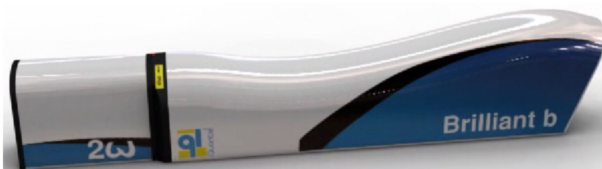
Obrázok č. 10: Nd:YAG laser z laboratória ÚFI s 2\omega modulom.
