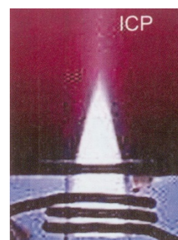
Obrázok č. 1b: Plazma indukovaná magnetickou indukciou [4, str.111].
