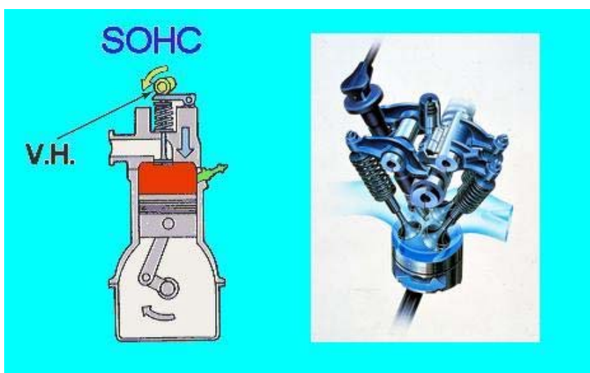
Obr. 3.9 : Schéma rozvodu SOHC a pohled na model rozvodu SOHC [ 11 ]
