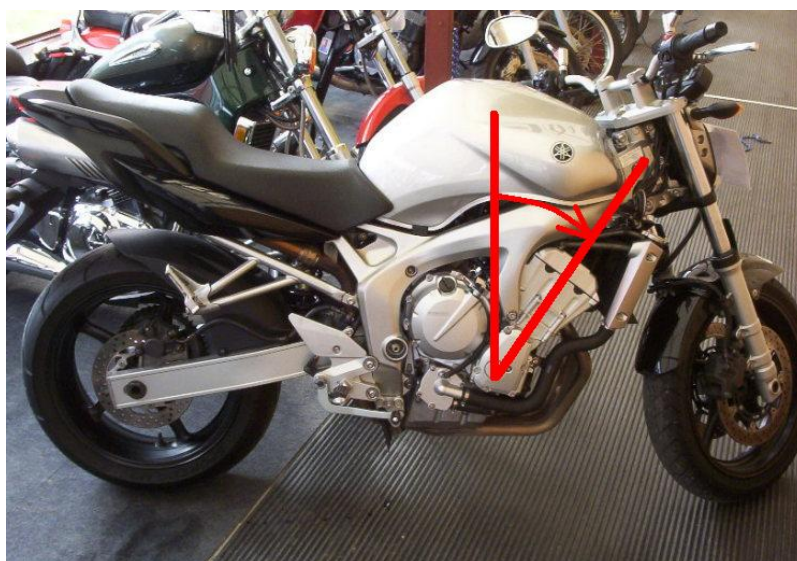
Obr. 1.9 : Naklonění osy motoru od svislé osy u motocyklu Yamaha 600 FZS Fazer [ 14 ]
