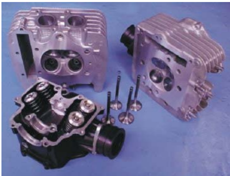
Obr. 3.4 : Příklad vzduchem chlazené hlavy válce s rozvodem SOHC a čtyřmi ventily [ 11 ]
