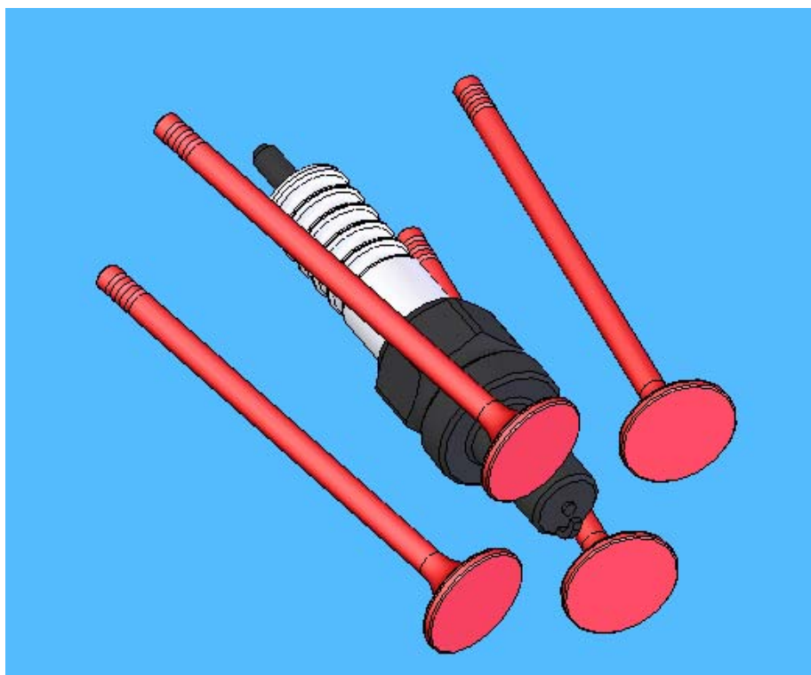
Obr. 10.7 : Umístění svíčky a ventilů
