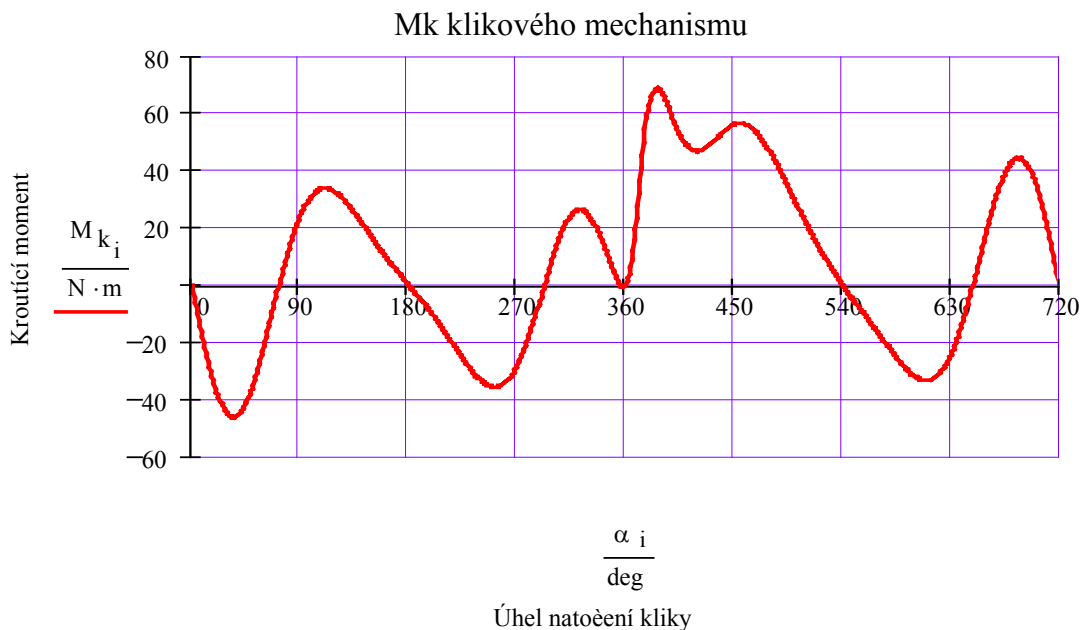
Graf 6.25 : Průběh kroučícího momentu motoru
