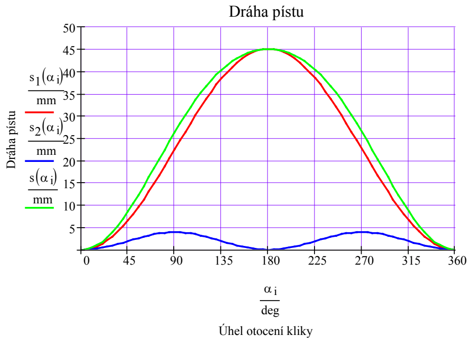
Graf 6.1 : Průběh dráhy pístu a její harmonických složek
