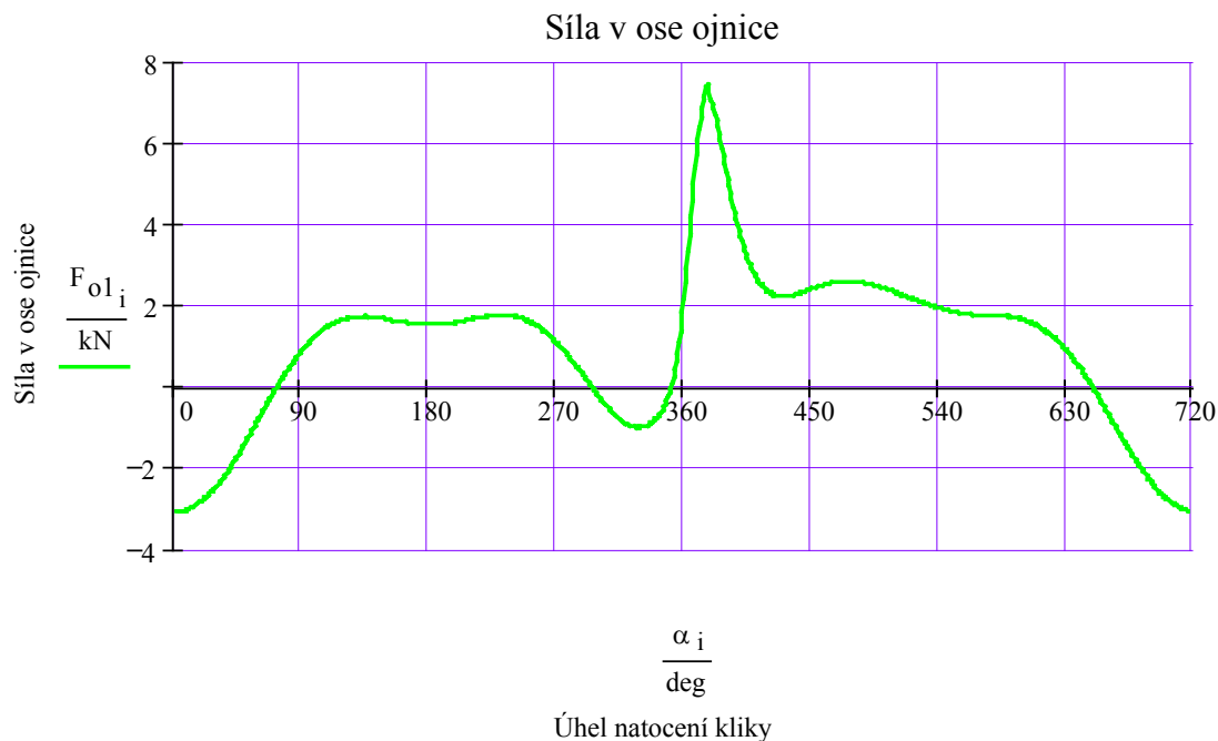
Graf 6.15 : Průběh síly v ose ojnice působící na pístním čepu
