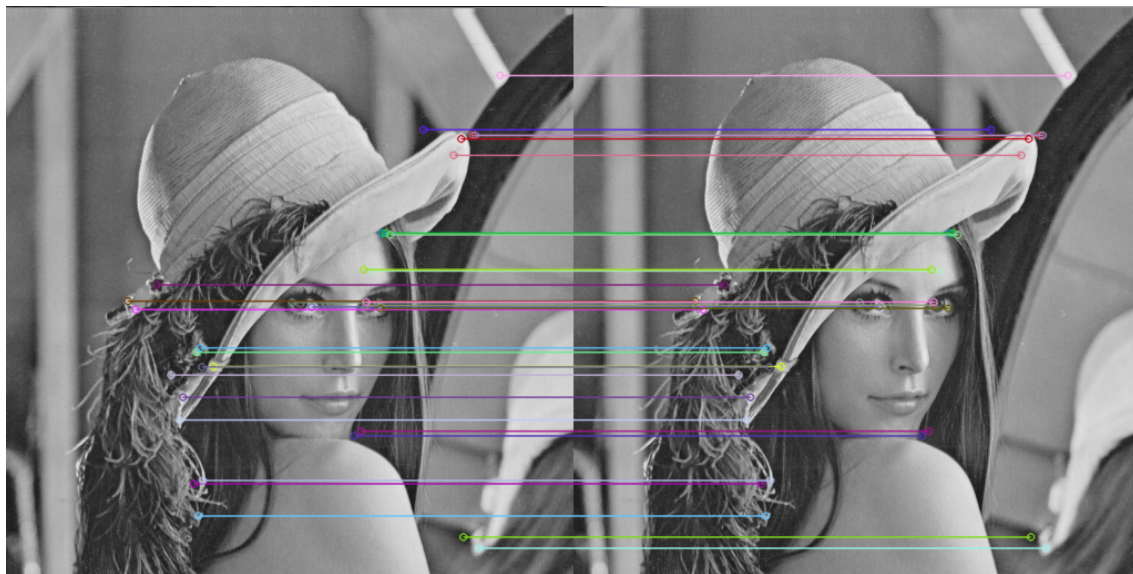
Obrázek 7: Modelový příklad srovnání nalezených příznaků na dvou stejných obrazech pomocí metody SURF.
