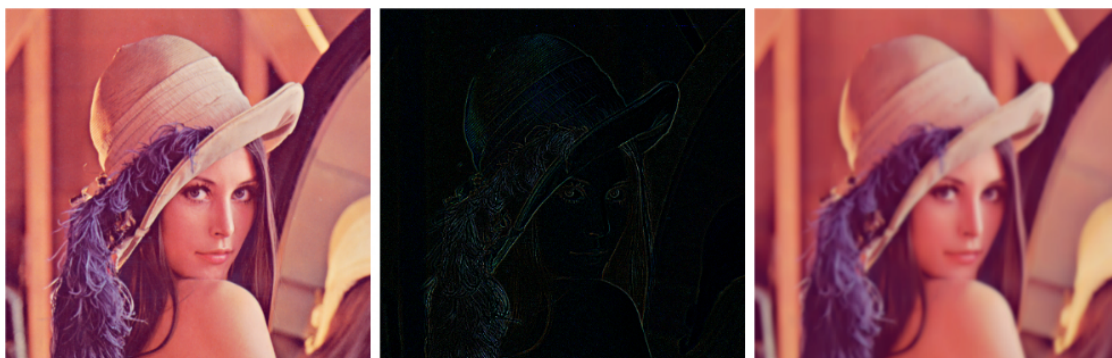
Obrázek 5: Ukázka vybraných lineárních filtrací; vlevo identita \begin{bmatrix} 0 & 0 & 0 \\ 0 & 1 & 0 \\ 0 & 0 & 0 \end{bmatrix} , uprostřed La-
