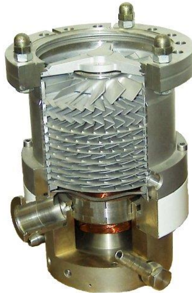
Obrázek 17: Řez turbomolekulární vývěvou zobrazující řazení vícera turbín za sebou, převzato z [19].
