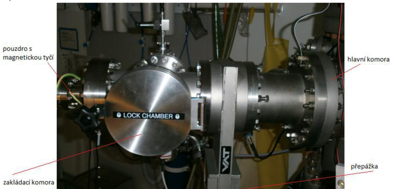
Obrázek 20: Zakládací komora, spolu s hlavní komorou, ventilem a pouzdem s magnetickou tyčí.
