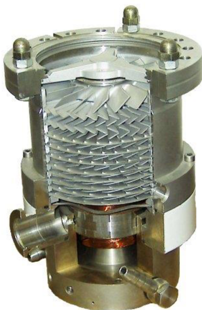
Obrázek 17: Řez turbomolekulární vývěvou zobrazující řazení vícera turbín za sebou, převzato z [19].
