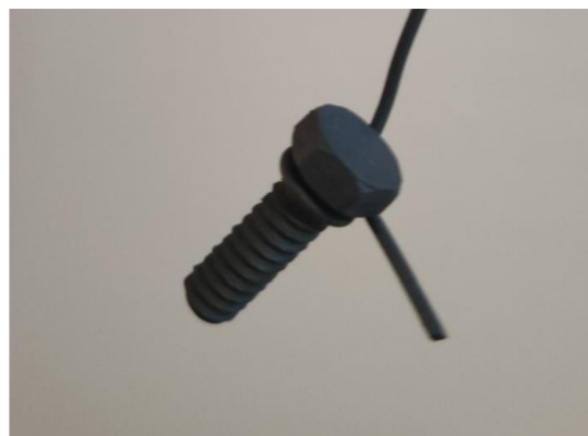
Obrázok 17 3D výtlačok nastriekaný grafitovým sprejom
