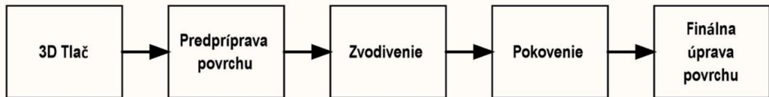
Obrázok 1 Bloková schéma postupu práce pri pokovení 3D výtlačku
