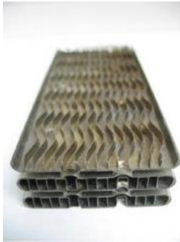
Obr. 7 - Chladič konstruovaný vrstvením plechů [17]
