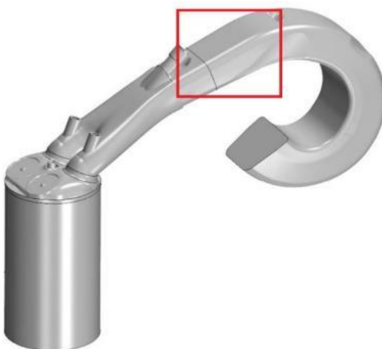
Obrázek 56 - Místo aplikace EGR segmentu zobrazené na sériovém sacím potrubí
