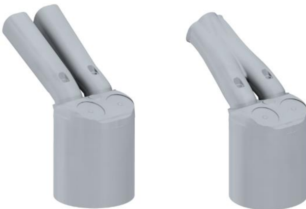
Obr. 31 - Spalovací prostor s přímými separovanými kanály (vlevo) a spalovací prostor s přímými sdruženými kanály (vpravo)
