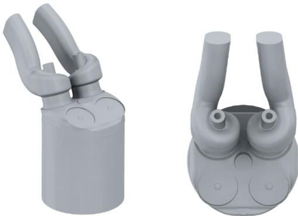
Obr. 30 - Spalovací prostor se šroubovými kanály
