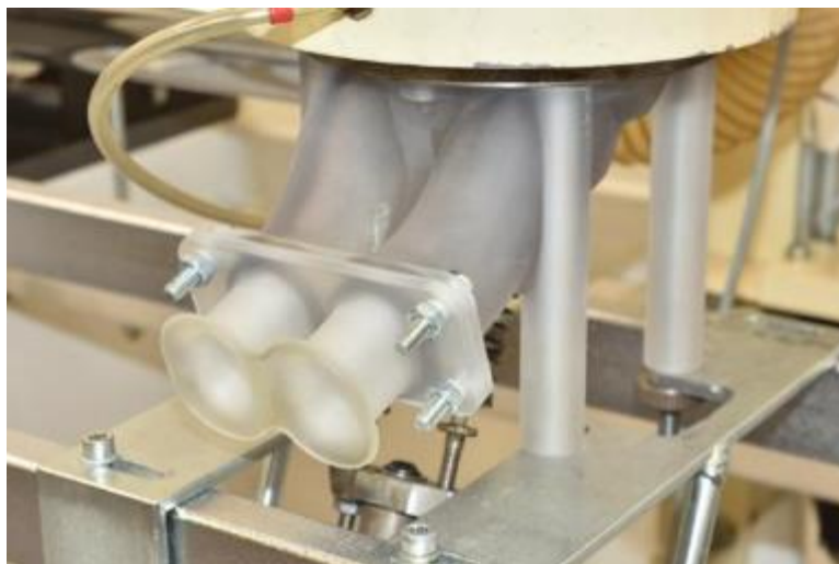
Obr. 44 - Flowbox upnutý na testovacím zařízení
