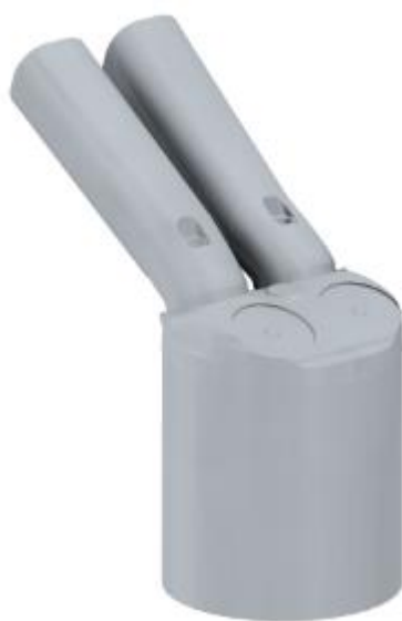
Obr. 34 - Spalovací prostor s přímými separovanými kanály
