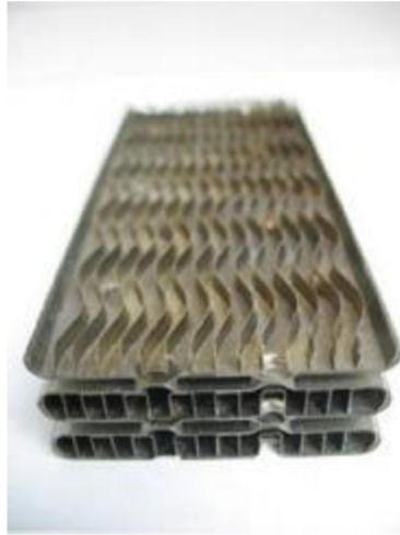
Obr. 7 - Chladič konstruovaný vrstvením plechů [17]
