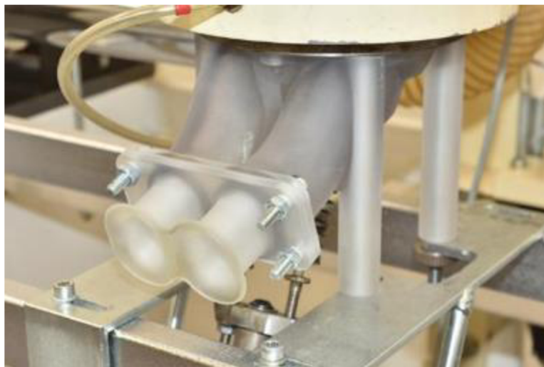
Obr. 44 - Flowbox upnutý na testovacím zařízení
