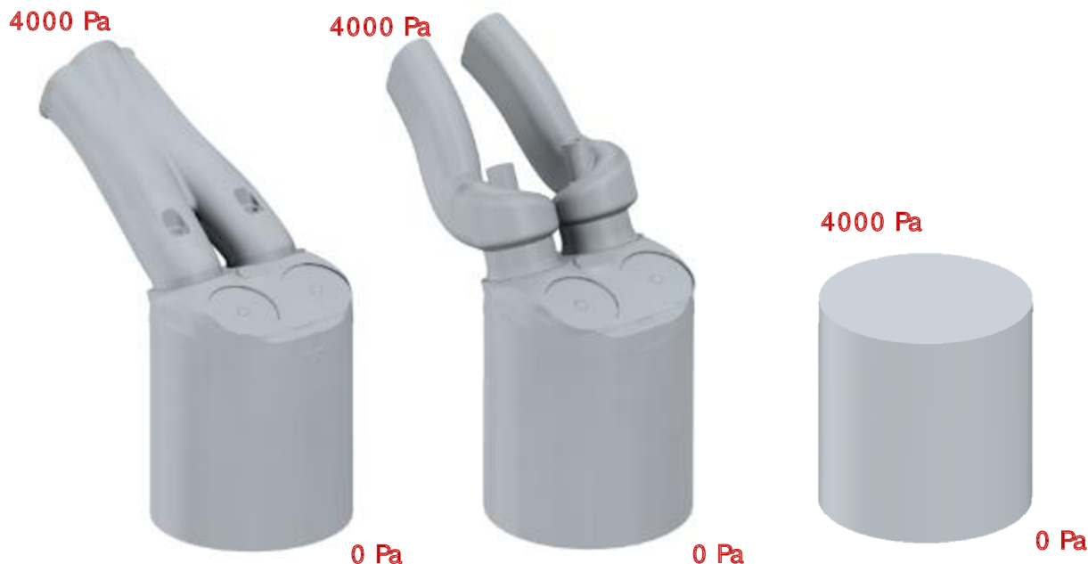
Obr. 35 - Sériová geometrie, Šroubová geometrie a volný válec s okrajovými podmínkami
