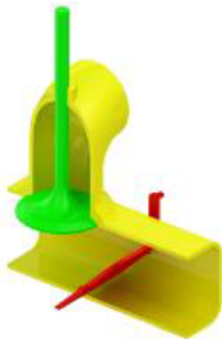
Obr. 52 - Segment sacího potrubí s EGR ventilem a přepínací klapkou
