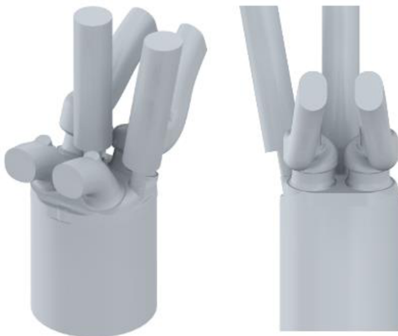
Obr. 50 - Umístění zapalovacích svíček pro novou geometrii
