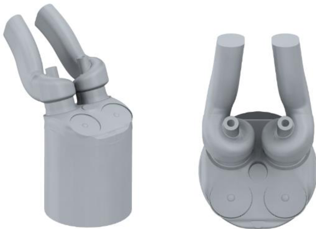
Obr. 30 - Spalovací prostor se šroubovými kanály
