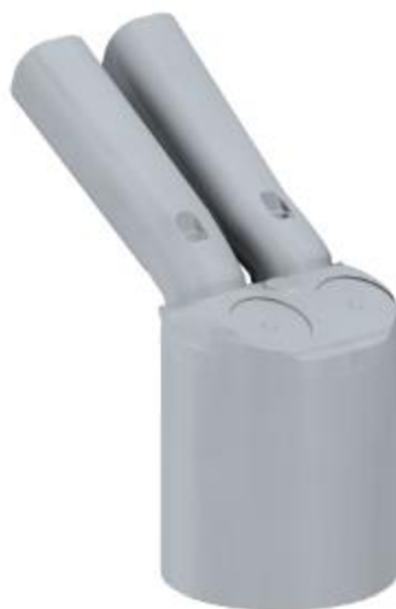
Obr. 34 - Spalovací prostor s přímými separovanými kanály
