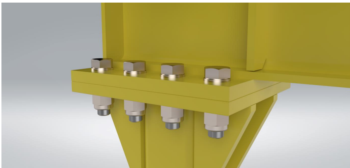
Obr. 26 Šroubový spoj nosníku a podpěr
