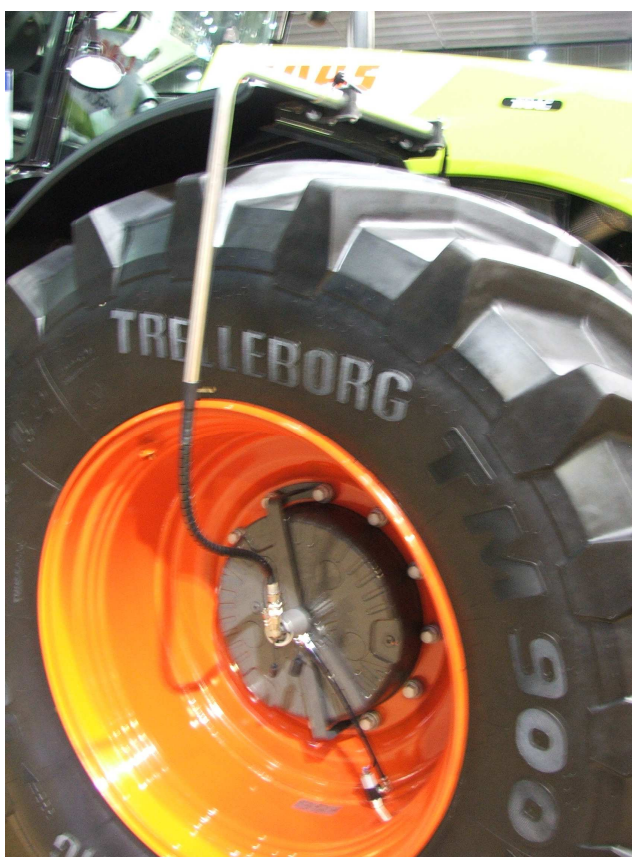
Obr. 15: Moderní širokoprofilová, nízkotlaká pneumatika se zařízením pro řízení tlakem
