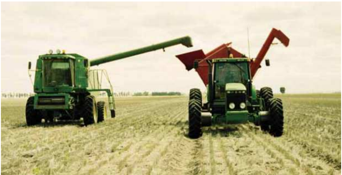
Obr. 24. Ukázka sjednoceného rozchodu strojů (Chamen, 2011)
