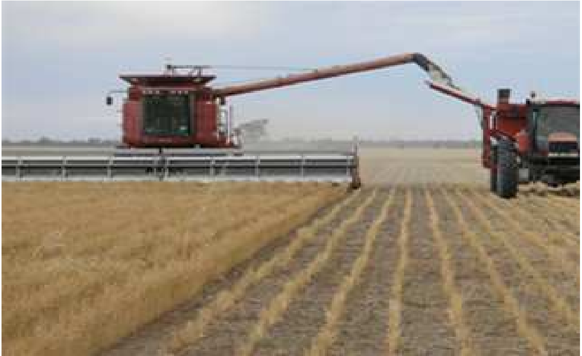
Obr. 33. Sklizeň obilovin v šířce CTF 12 metrů Tullberg et al (2007)
