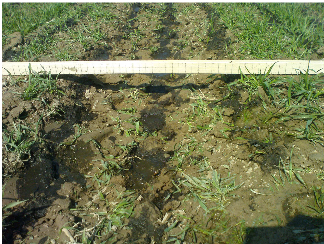
Obr. 2: Snímek stopy po přejezdu soupravy aplikující digestát z BPS
