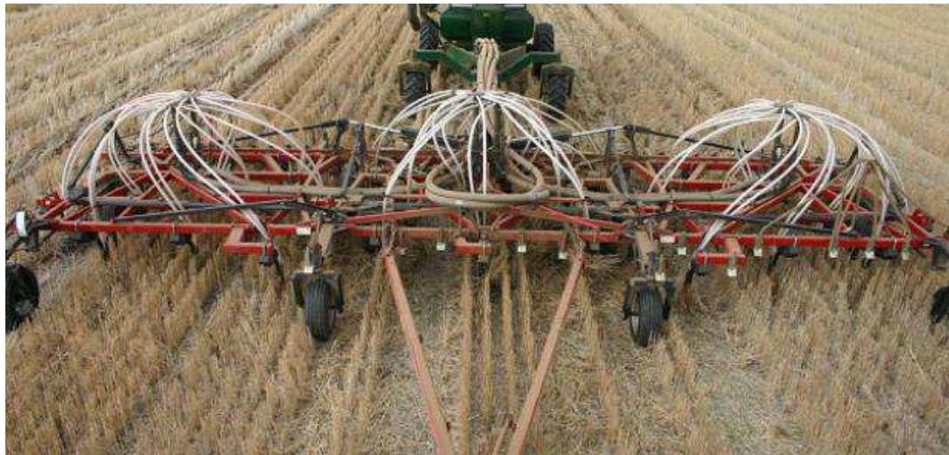
Obr. 23. Přímé setí v systému CTF ( Conservation agriculture and controlled traffic farming, 2012 )
