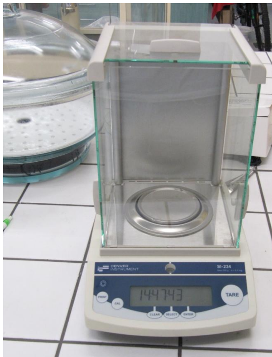
Obrázek 31 Laboratorní váha Denver Industries SI-234, nalevo exsikátor
